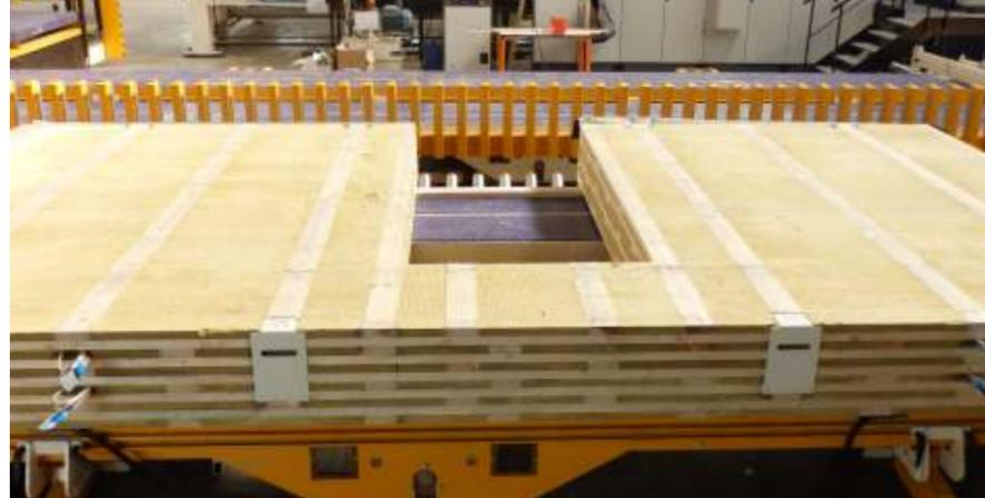
na tworzony panel. Całość jest prasowana w celu utwardzenia spoiny klejowej. Ostatnim etapem jest wyfrezowanie ostatecznego kształtu prefabrykatu poprzez wyrównanie wszystkich krawędzi panelu. Wszy-
